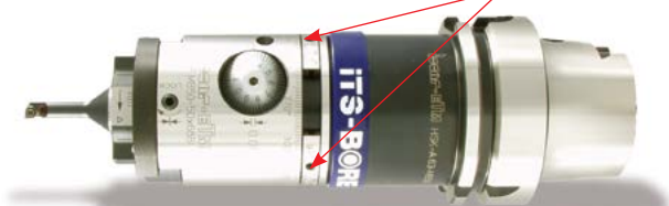
Балансировочные противовесы W1 и W2
