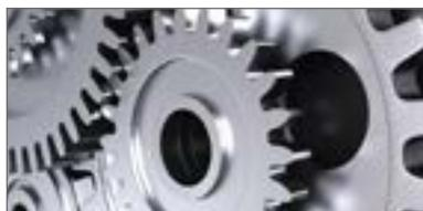
Прямозубые и косозубые зубчатые колеса с модулем 0,5-6,0 мм или диаметральным питчем DP 52-4.
