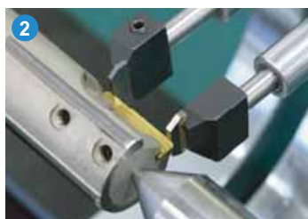
2. Вращайте развертку для определения отклонений индикатора
