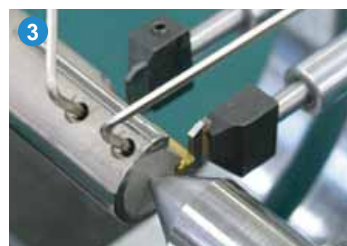
3. Отрегулируйте положение режущей пластины при помощи регулировочных винтов:
