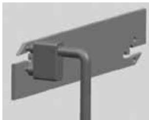
Вставьте ключ в отверстие на державке
