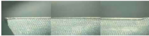
ONLY ONE из быстрореж. стали PM60 с покрытием
