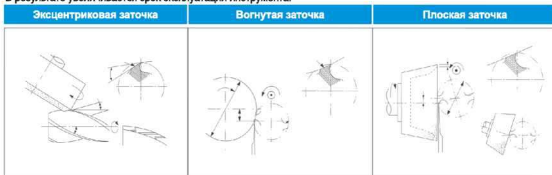
Рис. 3. Три способа заточки главного заднего угла
