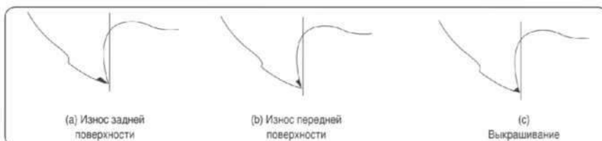
Рис. 1. Виды износа режущей кромки
